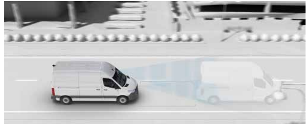
El asistente de frenado activo puede ayudar a impedir accidentes con los vehículos precedentes y con peatones cruzando la vía, o al menos a reducir sus secuelas.
