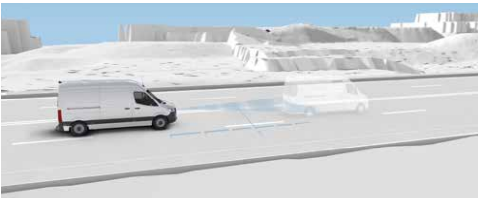
El asistente activo de distancia DISTRONIC puede mantener la separación ajustada por el conductor respecto al vehículo precedente y le facilita la conducción en tramos de autopista o en tráfico denso.
